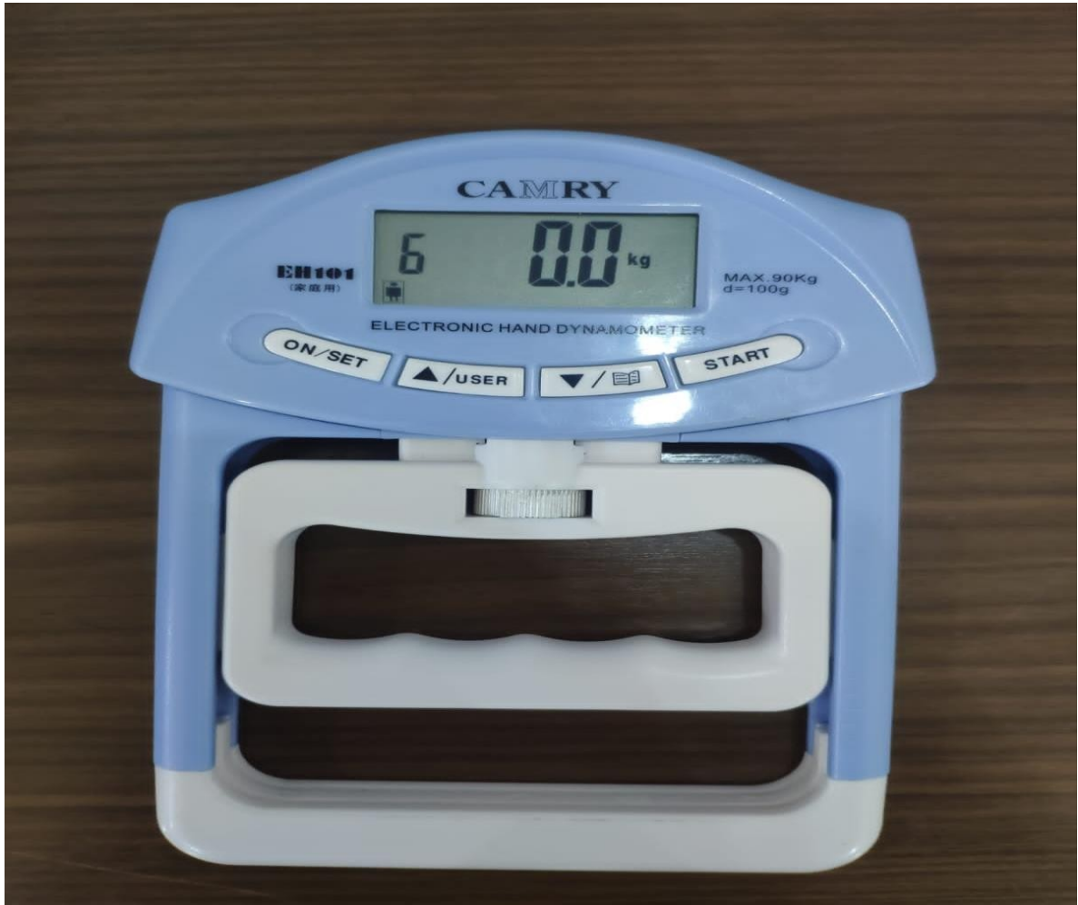
Şəkil 4.1.1. Əl əzələlərinin gücünü ölçmək üçün dinamometr
