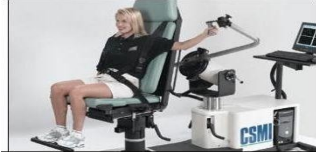
Şəkil 2.2. İzokinetik dinamometr çiyin diaqonalının ölçülməsi
