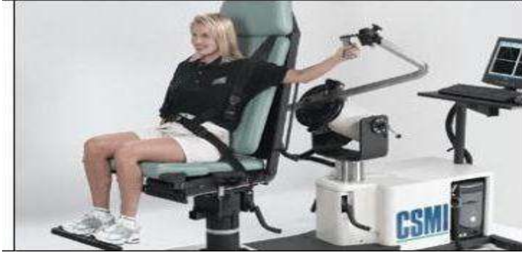
Şəkil 2. İzokinetik dinamometr çiyin diaqonalının ölçülməsi.
